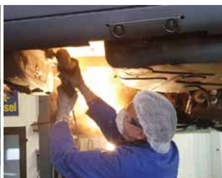
... die mühsame Entfernung des Unterbodenschutzes.
