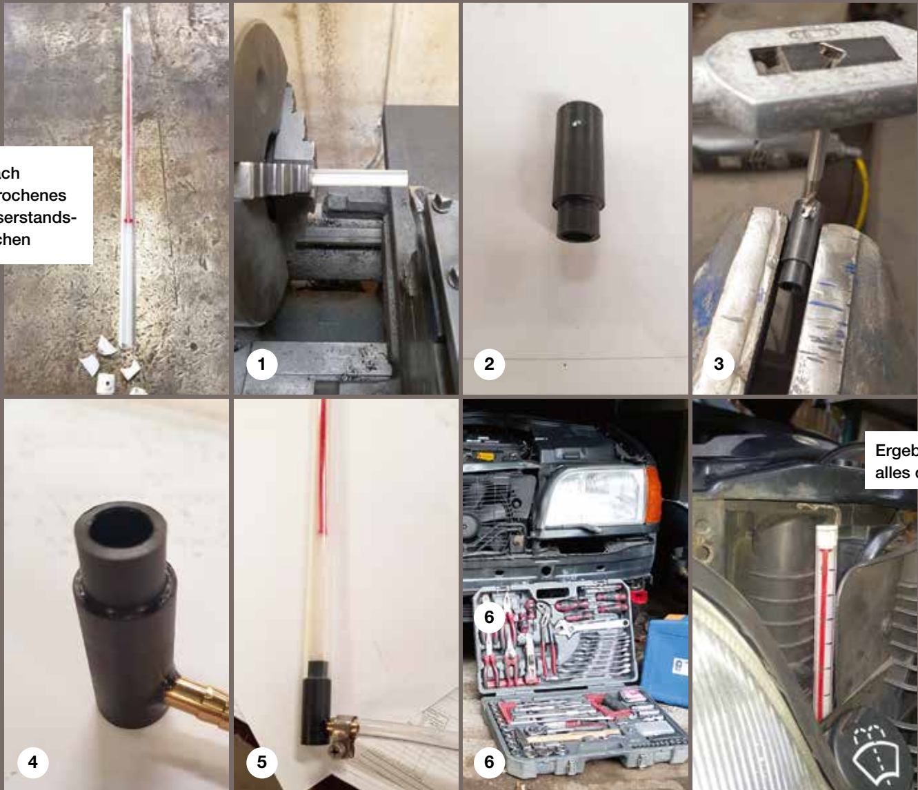
Schritt 1: Röhrchen plandrehen Schritt 2: neues Endstück anfertigen Schritt 3: M6-Gewinde einschneiden
